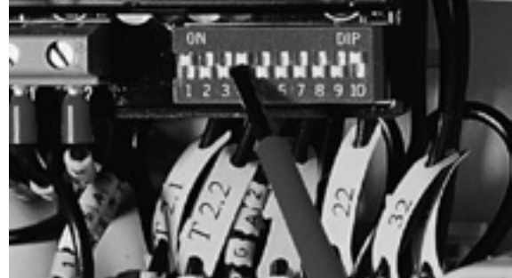
Rys. 15 Ustawianie przełączników DIP na jednostce CU 2XX
