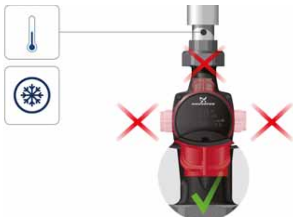
Rys. 4 Pozycja skrzynki sterowniczej w instalacjach klimatyzacyjnych i zimnej wody
